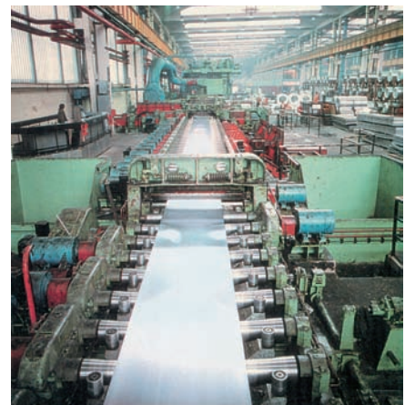
Εικόνα 30.5: Εργοστάσιο παραγωγής φύλλων αλουμινίου
