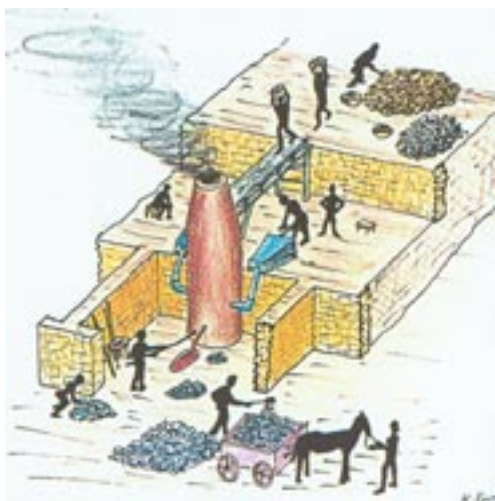
Κάμινος τήξης μεταλλεύματος. (Αναπαράσταση: Κ. Κονοφάγος.)
