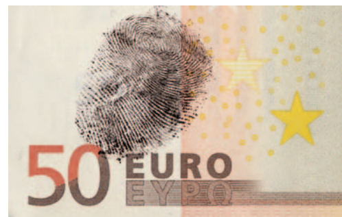
Εικόνα 1.8 Μια εξαιρετικά ευαίσθητη τεχνική για τη λήψη δακτυλικών αποτυπωμάτων στηρίζεται στο γεγονός ότι τα ανόμοια φορτισμένα σώματα έλκονται. Έτσι τα αρνητικά φορτισμένα σωματίδια του χαρτονομίσματος προσκολλώνται στις θετικά φορτισμένες πρωτεΐνες των δακτύλων που παραμένουν στο χαρτονόμισμα κάθε φορά που το αγγίζουμε.
