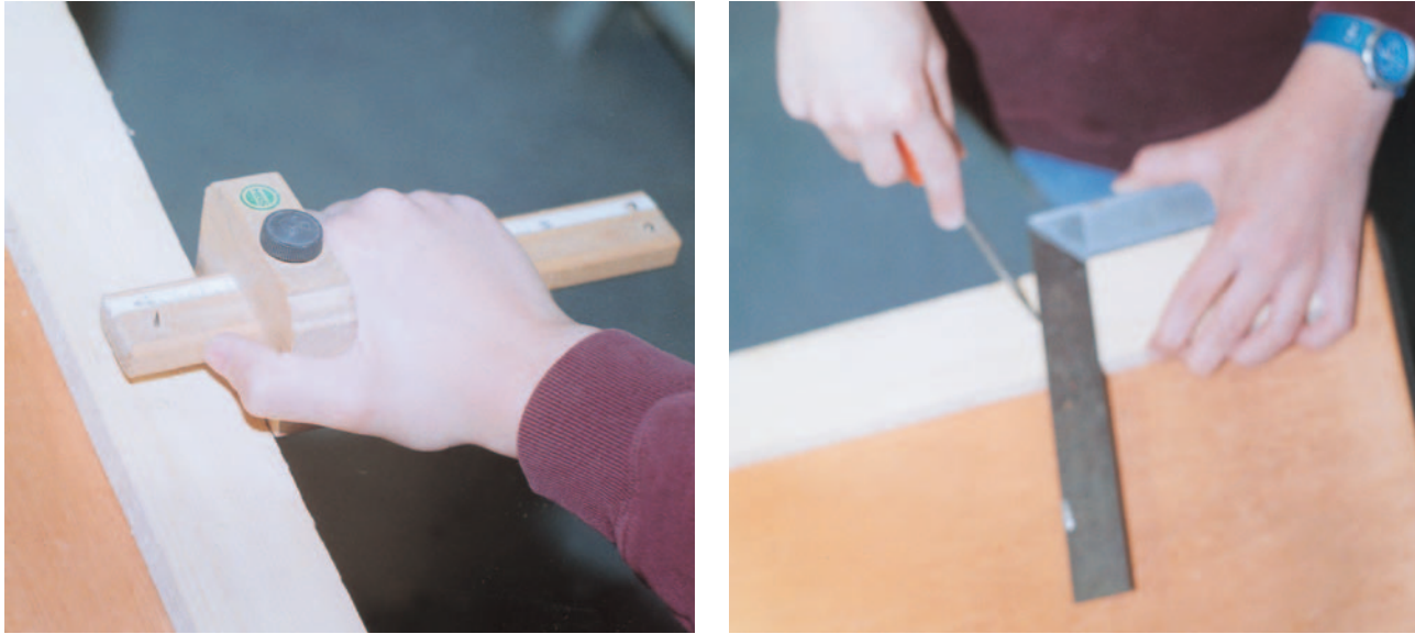
Εικόνα 4.12: Χάραξη ευθειών με τη βοήθεια σηματούρας και γωνιάς
