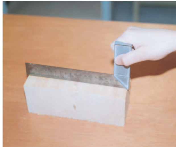
Εικόνα 4. 10: Έλεγχος γωνιάσματος και επιπεδότητας.
