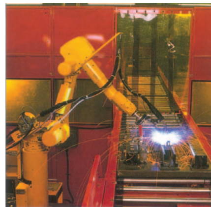
Εικ. 12 Βιομηχανικός ρομποτικός βραχίονας που χρησιμοποιείται για συγκόλληση.
