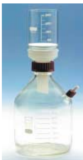
Σχήμα 3.9: Διάταξη διήθησης υπό ελαττωμένη πίεση. Δεξιά η υποδοχή για την υδραντλία.
