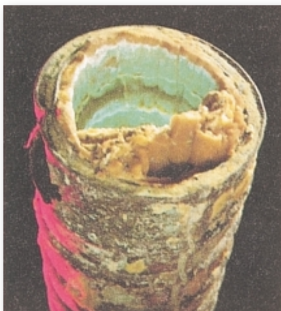
Συσσώρευση ανθρακικού ασβεστίου σε σωλήνα νερού. Το στρώμα που σχηματίζεται στο εσωτερικό του σωλήνα παρεμποδίζει την ελεύθερη ροή του νερού.
