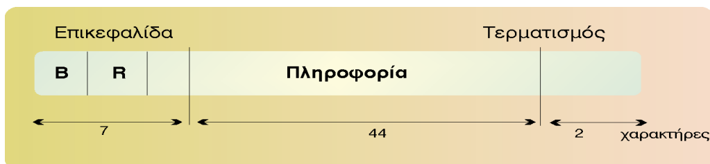
Σχήμα 15.10: Το πλαίσιο του DQDB
