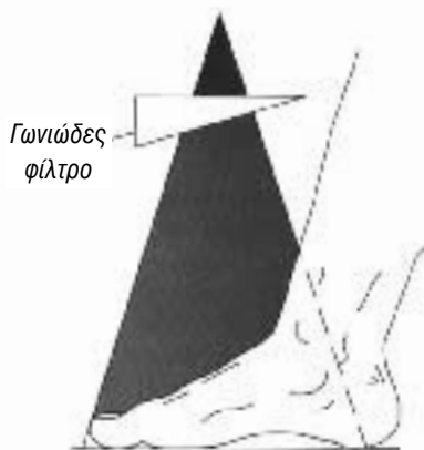
Σχ. 1.5.: Τοποθέτηση του γωνιώδους φίλτρου
