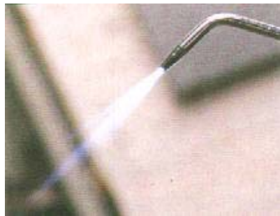
Σχήμα (5.23): Η φλόγα μετά τη ρύθμισή της (ουδέτερη)
