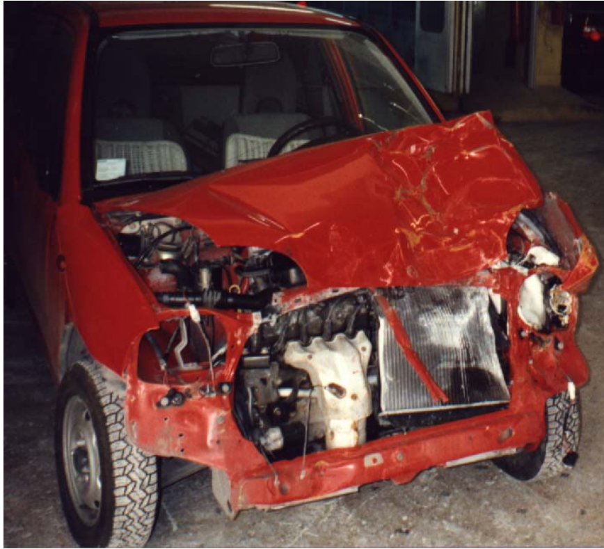
Σχήμα 4.12 Μετωπική σύγκρουση αυτοφερόμενου αμαξώματος
