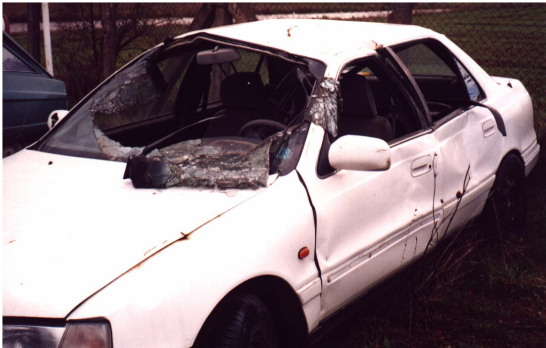
Σχήμα 4.15 Παραμόρφωση αυτοφερόμενου αμαξώματος μετά από περιστροφή (ντελαπάρισμα)
