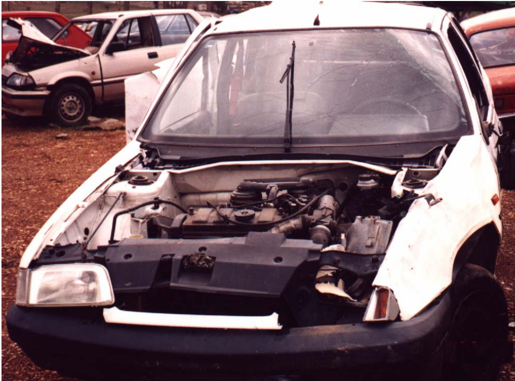
Σχήμα 4.14 Παραμόρφωση (κάμψη) σε οριζόντιο επίπεδο αυτοφερόμενου αμαξώματος από πλευρική σύγκρουση
