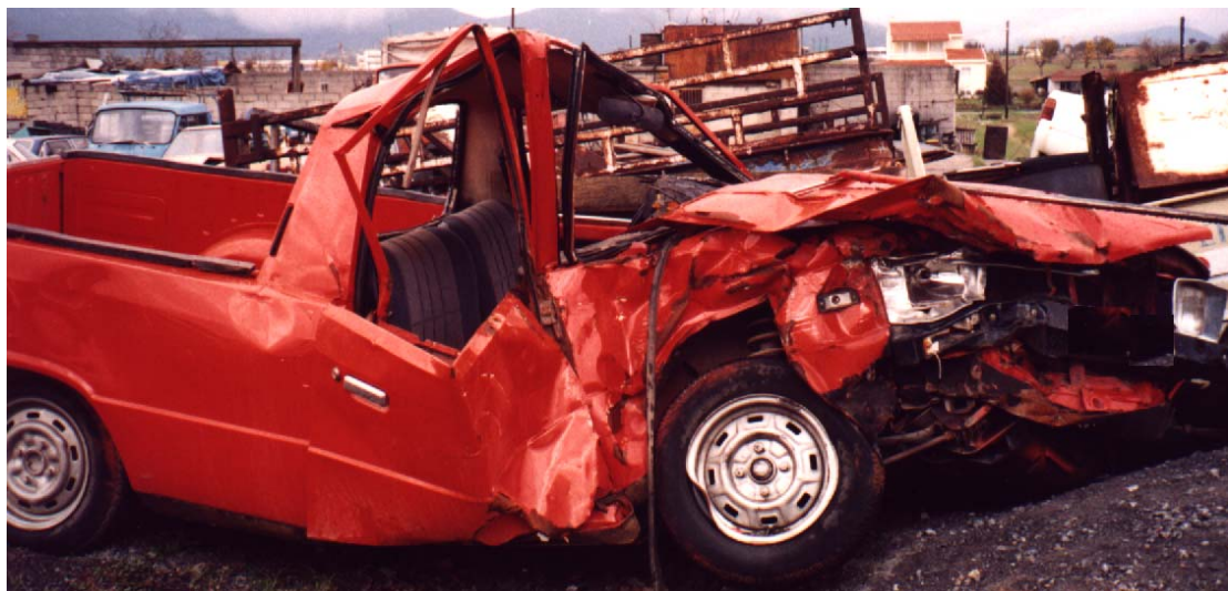
Σχήμα 4.13 Παραμόρφωση αυτοφερόμενου αμαξώματος από πλαγιομετωπική σύγκρουση
