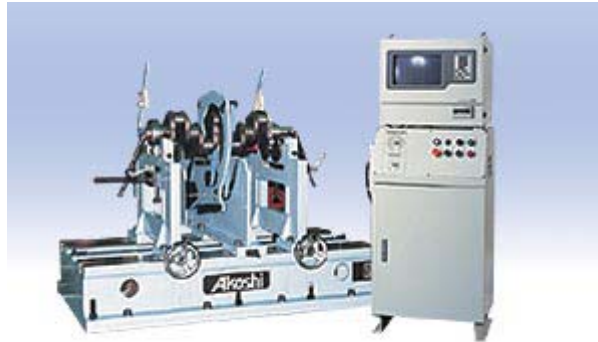
Σχήμα 2.111 Μηχανή ζυγοστάθμισης στροφαλοφόρου άξονα αεροπορικού κινητήρα με τον κατάλληλο εξοπλισμό επεξεργασίας των μετρήσεων
