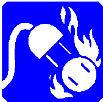
Σχήμα 2.54 Σήμα πυρκαγιάς κατηγορίας C και πυροσβεστήρας
