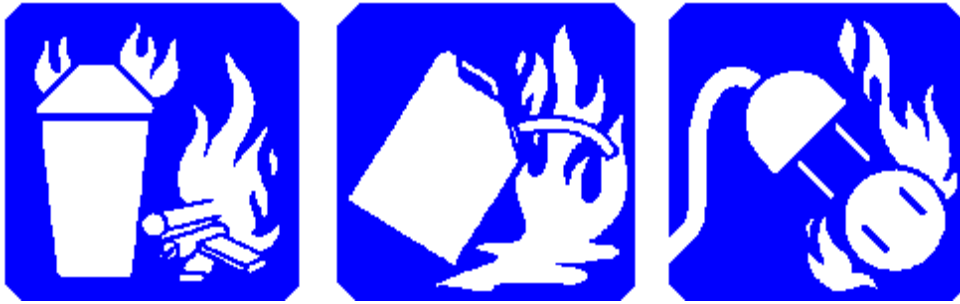
Σχήμα 2.55 Σήμανση πυροσβεστήρα κατάλληλου για πυρκαγιές τύπου Α,Β,С
