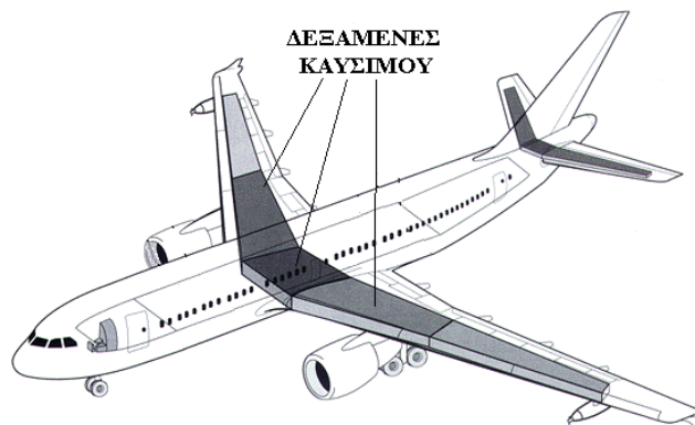
Σχήμα 3.35 Θέση δεξαμενών καυσίμου αεροσκάφους
