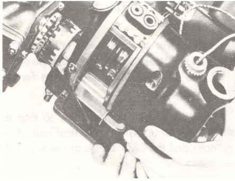
Σχήμα 2.126 Ρύθμιση του αντικραδασμικού συνδέσμου
