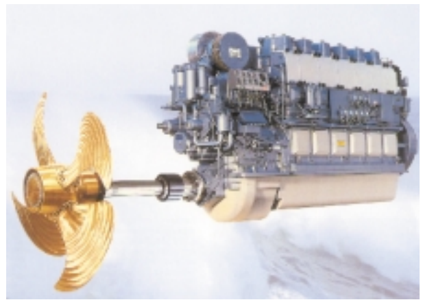
Φωτογραφία 5.1 : Έλικα μεταβλητού βήματος κινούμενη από μηχανή Diesel
