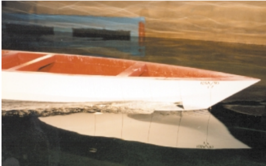
Φωτογραφία 4.1 Το ξύλινο πρότυπο του πλοίου της φωτογραφίας 4.2 στην Πειραματική Δεξαμενή.
