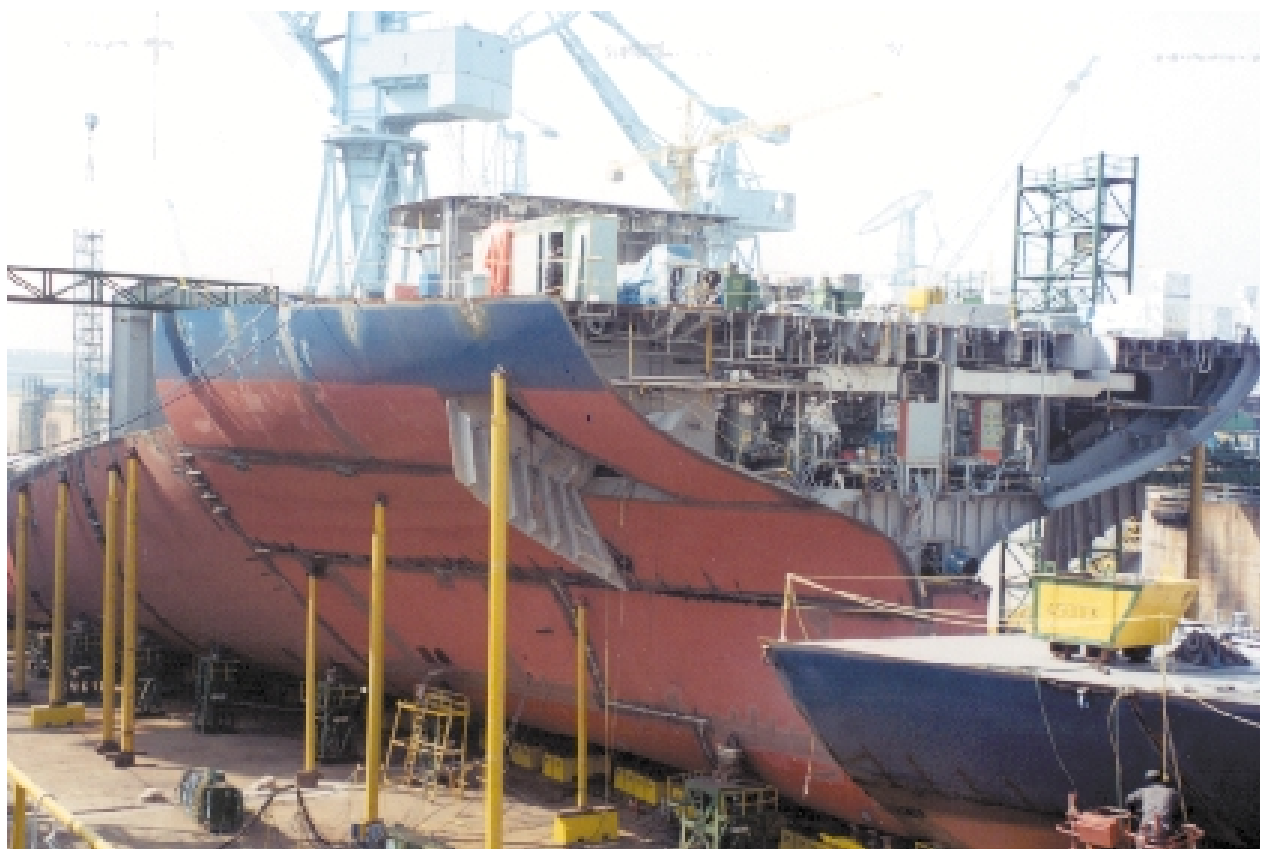
Φωτ. 9.3 Πουρναίο μέρος, λίγο πριν την ολοκλήρωσή του
