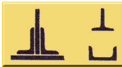
Σχήμα 1.18 Μαύρισμα τομής μικρού πάχους αντικειμένων
