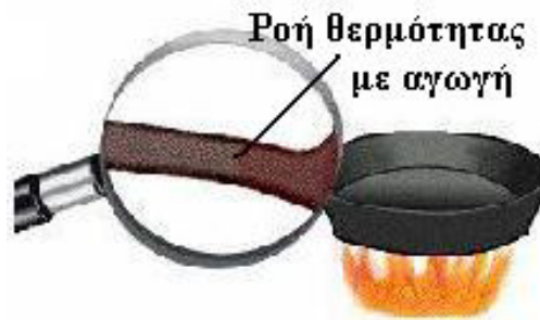
Σχήμα 1.8 Η θέρμανση της λαβής γίνεται μέσω «αγωγής»
