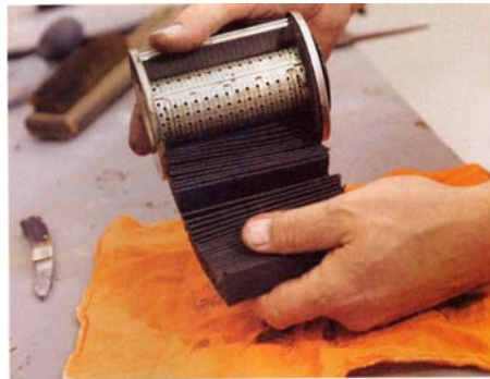
Σχήμα 2.6 Καταστροφικός έλεγχος φίλτρου ελαίου
