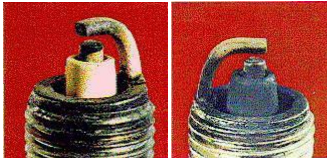
Σχήμα 2.7 (α) "Υγιής" και (β) προβληματικός σπινθηριστής
