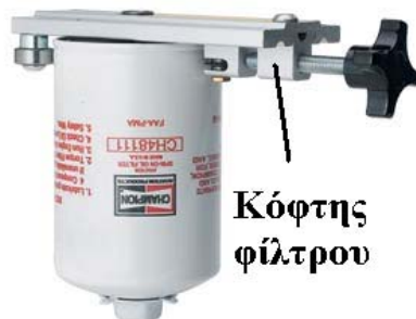
Σχήμα 2.6 Καταστροφικός έλεγχος φίλτρου ελαίου
