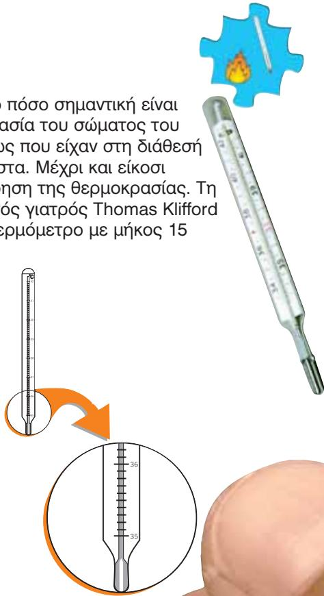
Με τη βοήθεια των εικόνων μπορείς να καταλάβεις τη διαφορετική λειτουργία του ιατρικού θερμομέτρου. Στο κάτω μέρος του λεπτού σωλήνα, κοντά στο μικρό δοχείο με τον υδράργυρο, υπάρχει ένα στένεμα. Όταν η θερμοκρασία αυξάνεται, ο υδράργυρος πιέζεται και περνά από το στένεμα στο λεπτό σωλήνα. Το στένεμα είναι τέτοιο, ώστε η αντίστροφη πορεία να είναι πιο δύσκολη. Μόνο με το «τίναγμα» ο υδράργυρος περνά πάλι στο μικρό δοχείο.
