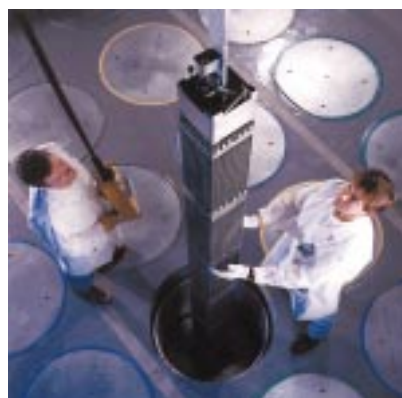
Ράβδοι πυρηνικού καυσίμου τη στιγμή που τις κατεβάζουν στη καρδιά του αντιδραστήρα.
