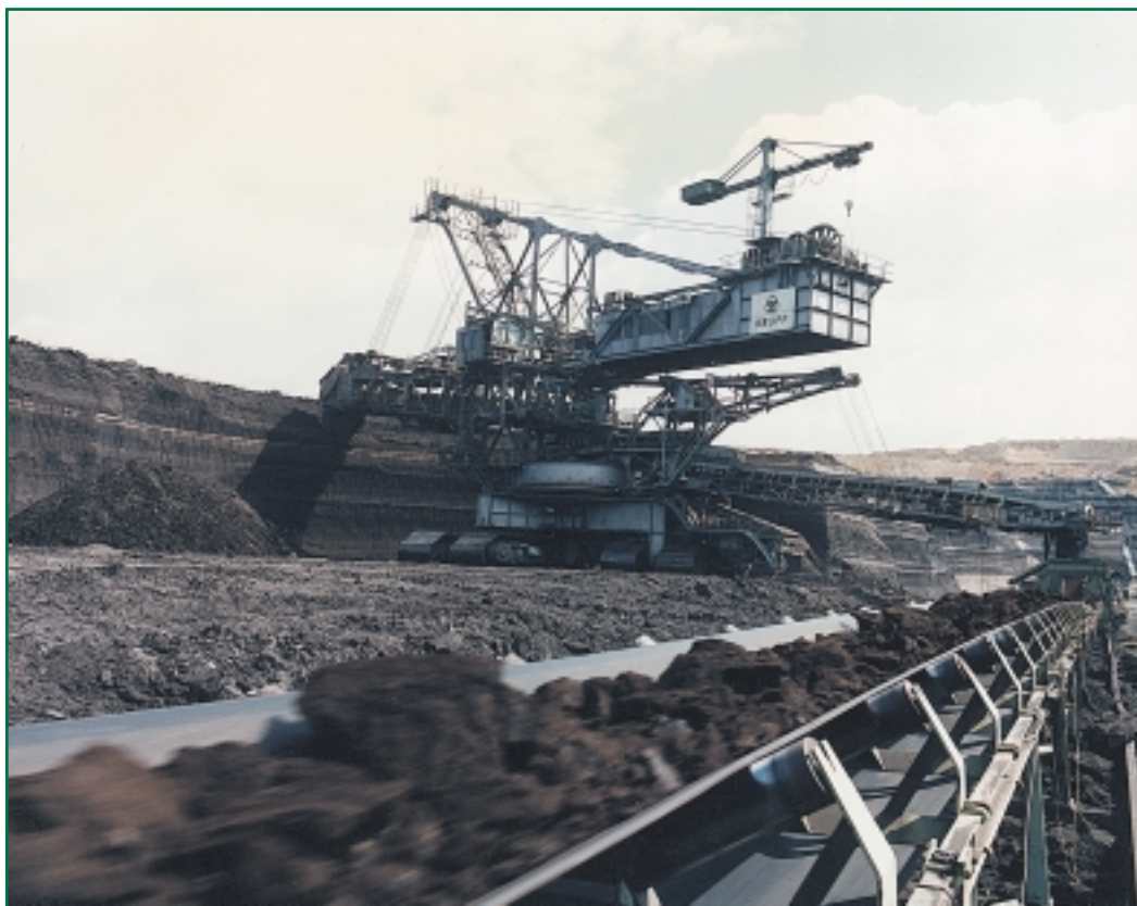
Εικόνα 1.1.9 Αυτόματο σύστημα εκσκαφής, εξόρυξης και μεταφοράς λιγνίτη (καδοφόρος εκσκαφέας)
