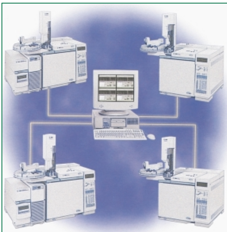
Εικόνα 1.1.2 Τέσσερις αέριοι χρωματογράφοι με ανιχνευτές φασματογράφους μάζας (GC/MSD), συνδεδεμένοι με Η/Υ
