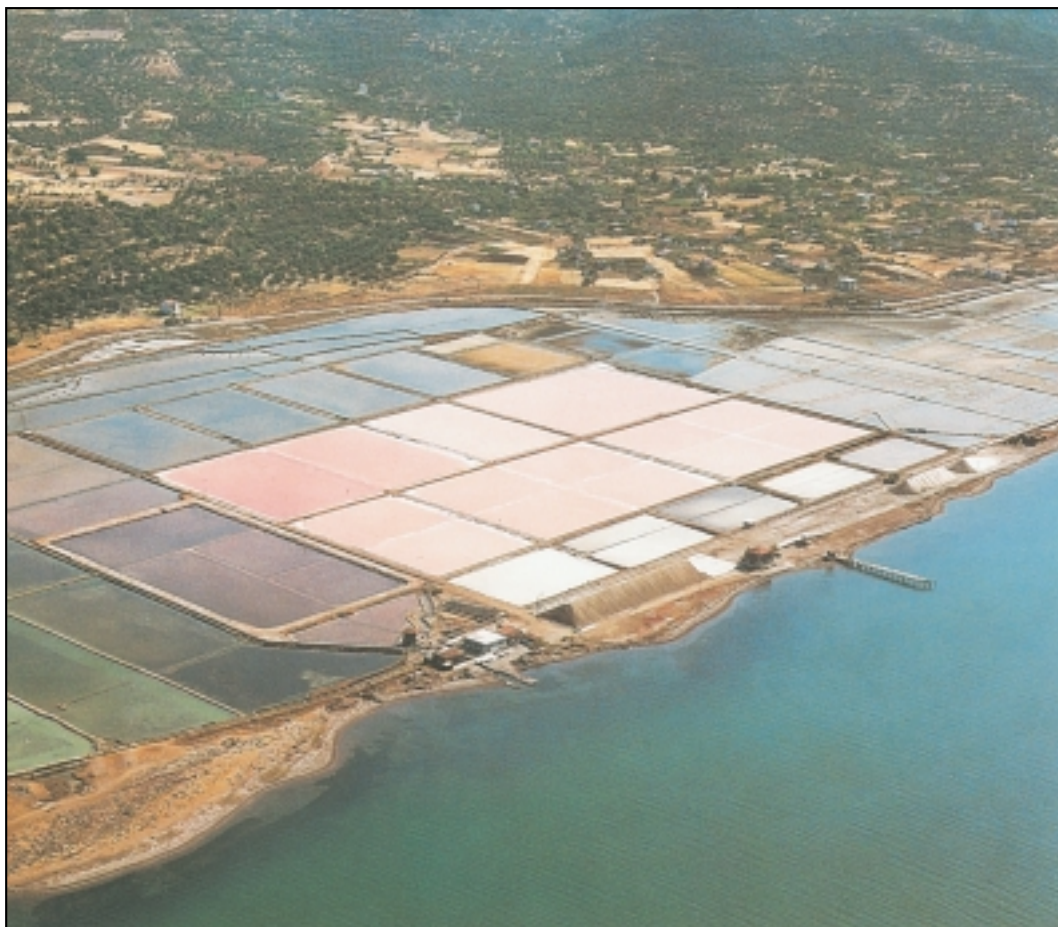
Εικόνα 3.1 Αλυκές. Στις αλυκές χρησιμοποιείται η μέθοδος της εξάτμισης για την εξαγωγή του αλατιού από το θαλασσινό νερό
