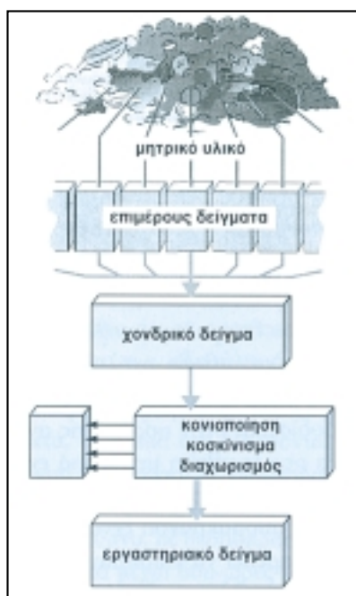
Σχήμα 4.1 Σχηματική απεικόνιση δειγματοληψίας στερεών απορριμμάτων
