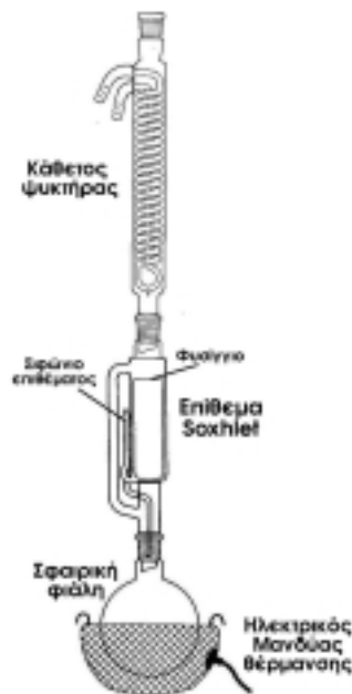
Εικόνα 2.1 Συσκευή Soxhlet
