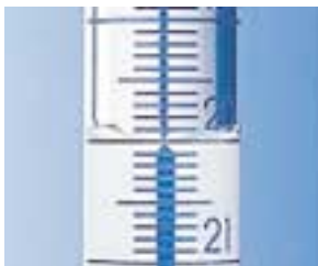
Σχήμα 3.1: Μηνίσκος και η ένδειξη είναι 20,00 mL.
