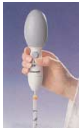
Εικόνα 5.3: Πιπέτα με μηχανισμό για αυτόματη αναρρόφηση.
