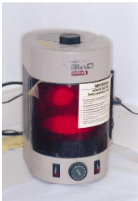
Εικ. 7.7. Συσκευή φωτοπολυμερισμού ακρυλικών
