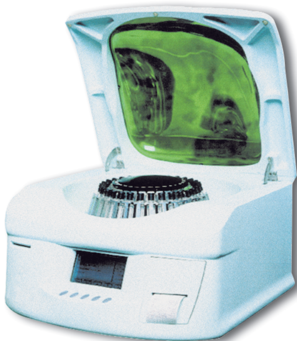
Σχήμα 14.1. Αυτόματο μηχάνημα μέτρησης Τ.Κ.Ε.
