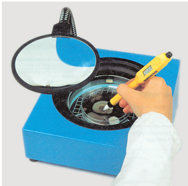
Σχήμα 14.3. Συσκευή μέτρησης αποικιών
