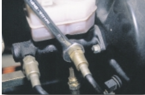
Σχήμα 2: Αφαίρεση σωληνώσεων παροχής υγρών φρένων.
