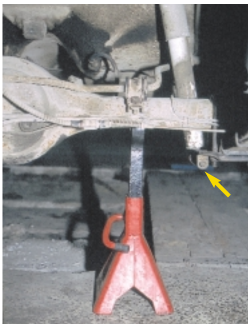
Σχήμα 2: Στήριξη του άξονα και αφαίρεση του αμορτισέρ.
