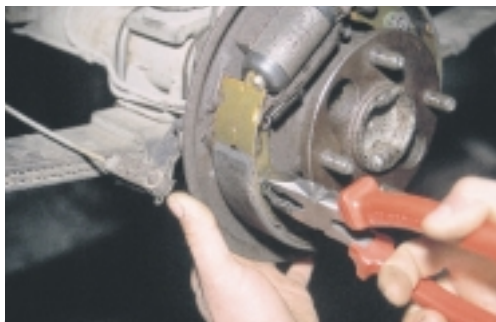
Σχήμα 4: Αφαίρεση ελατηρίου του πείρου στερέωσης.
