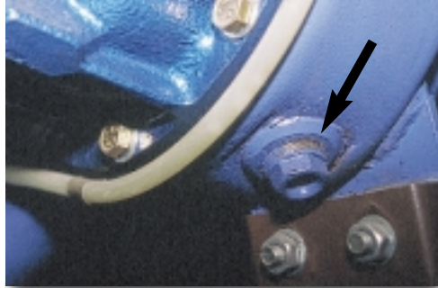
Σχήμα 2: Τάπα εκκένωσης λιπαντικού.
