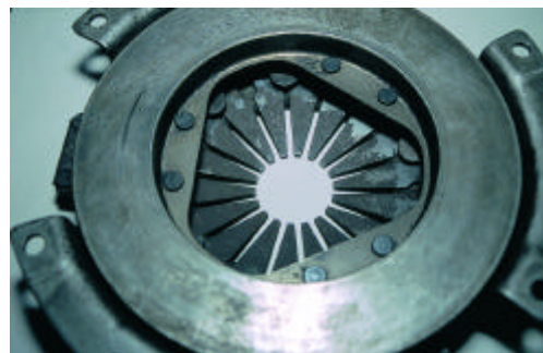
Σχήμα 5: Έλεγχος της πλάκας πίεσης.
