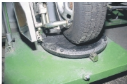
Σχήμα 7: Τοποθέτηση οχήματος στη συσκευή ευθυγράμμισης.
