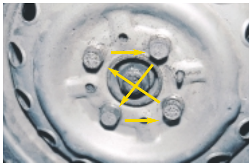
Σχήμα 2: Διαδικασία αφαίρεσης του τροχού.
