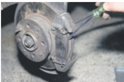
Σχήμα 6: Αφαίρεση τακακιών.
