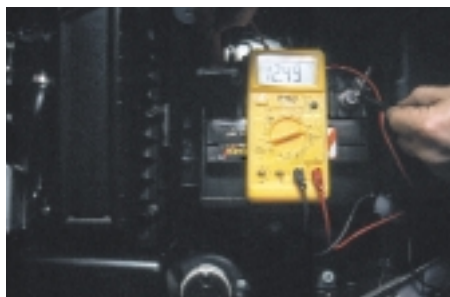
Σχήμα 5: Έλεγχος του συσσωρευτή με δοκιμαστικό και με βολτόμετρο.
