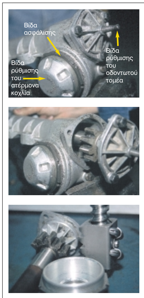
Σχήμα 6: Αφαίρεση ατέρμονα και οδοντωτού δομέα.
