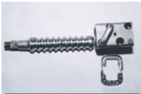
Σχήμα 7: Αφαίρεση περικοχλίων και σφαιριδίων.
