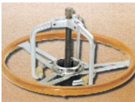
Σχήμα 4: Αφαίρεση του περικοχλίου συγκράτησης και του τιμονιού
