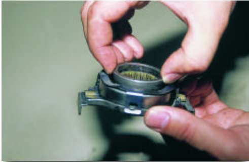
Σχήμα 8: Έλεγχος του ρουλεμάν πίεσης.
