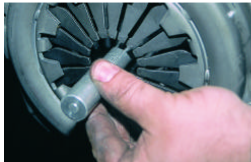
Σχήμα 11: Κεντράρισμα του δίσκου.
