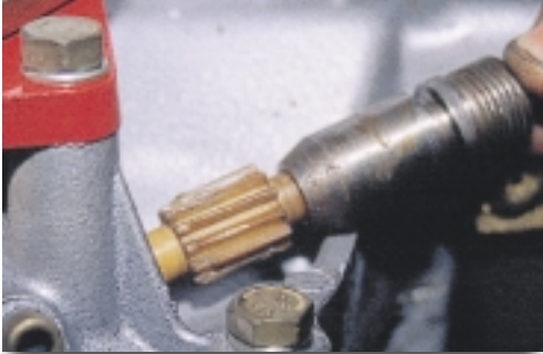
Σχήμα 19: Αφαίρεση του γραναζιού του χιλιομετρητή.
