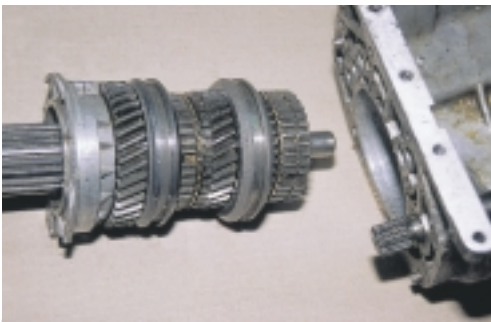
Σχήμα 20: Αφαίρεση του δευτερεύοντα άξονα.
