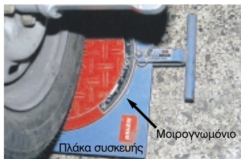
Σχήμα 2: Πλάκα και μοιρογνωμόνιο ευθυγράμμισης.
