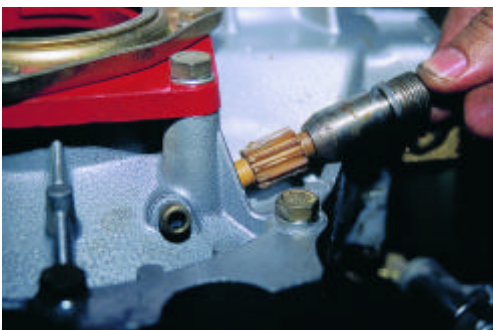
Σχήμα 6: Αφαίρεση της ντίζας του χαλιομετρητή.
