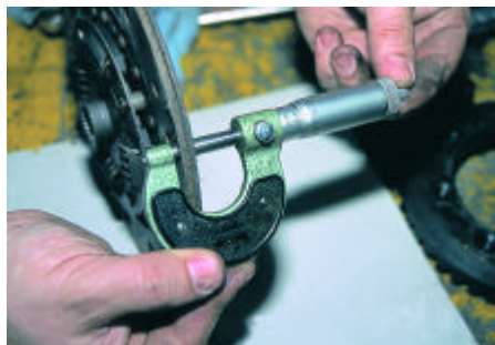
Μέτρηση πάχους του υλικού τριβής
