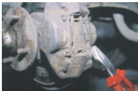
Σχήμα 7: Αφαίρεση των ασφαλειών των πείρων - οδηγών.
