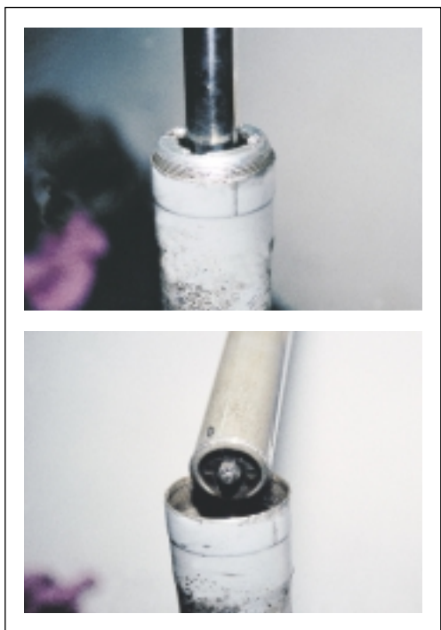
Σχήμα 7: Αφαίρεση του αμορτισέρ.
