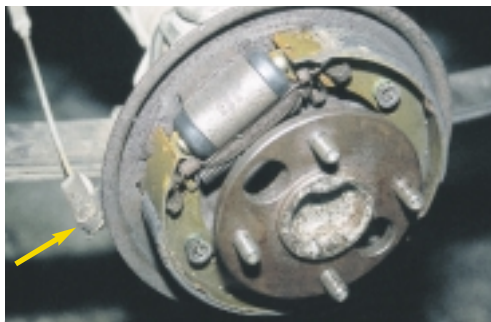
Σχήμα 5: Αποσύνδεση του μηχανισμού του χειρόφρενου.
