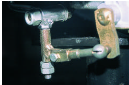
Σχήμα 3: Αποσύνδεση του μηχανισμού αλλαγής ταχυτήτων
