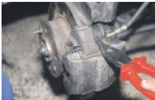
Σχήμα 3: Αφαίρεση των ασφαλειών των βάσεων της δαγκάνας.
