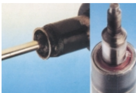
Καταστροφή στεγανωτικής διάταξης
