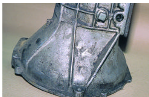
Σχήμα 4: Στήριξη του κιβωτίου ταχυτήτων.
