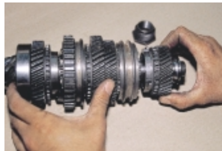
Αφαίρεση των γραναζιών και των "συγχρονιζέ"
