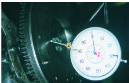
Έλεγχος παραμόρφωσης της επιφάνειας επαφής
