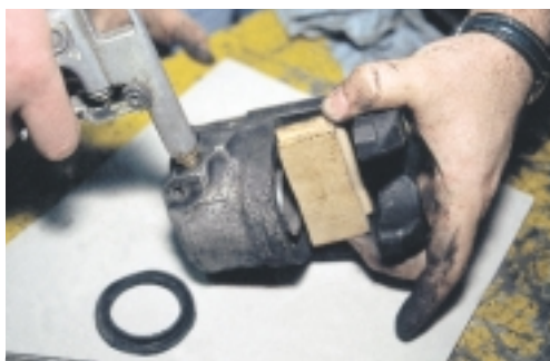
Σχήμα 11: Αφαίρεση εμβόλου δαγκάνας.
