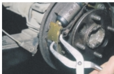
Σχήμα 3: Αφαίρεση επανατατικών ελατηρίων.
