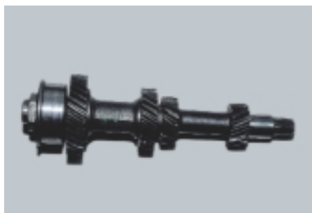
Σχήμα 17: Αφαίρεση του ενδιάμεσου άξονα.
