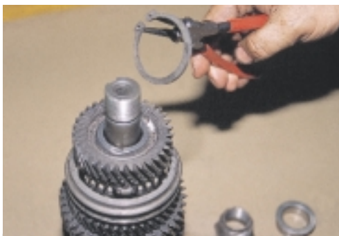
Σχήμα 1: Αφαίρεση της ασφάλειας του άξονα.
