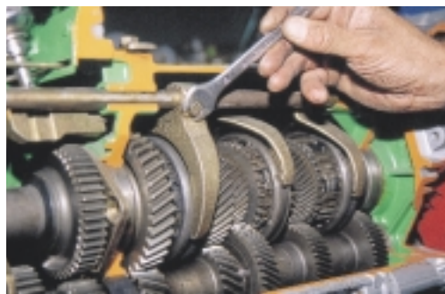
Σχήμα 16: Αφαίρεση των κοχλιών συγκράτησης των διχάλων.
