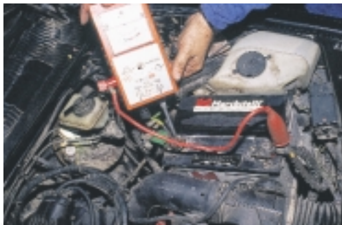
Σχήμα 6: Έλεγχος συσσωρευτή με βολτόμετρο ταχείας εκφόρτισης.
