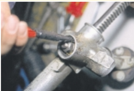
Απασφάλιση και αποσύνδεση του άξονα του πινιόν
