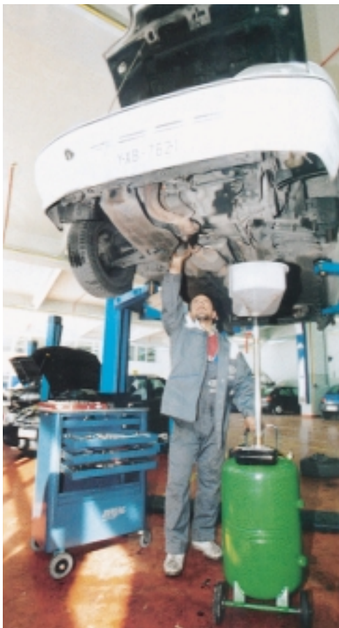
Σχήμα 1: Αντικατάσταση λιπαντικού κιβωτίου ταχυτήτων.
