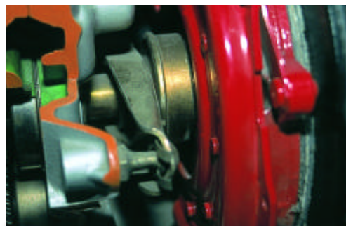
Σχήμα 2: Μηχανισμός συμπλέκτη.
