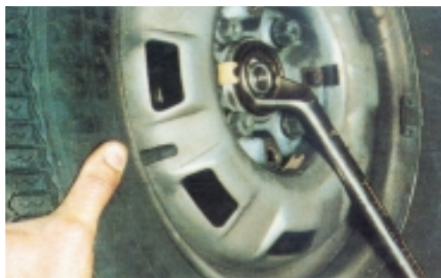
Σχήμα 3: Λασκάρισμα του κεντρικού παξιμαδιού.
