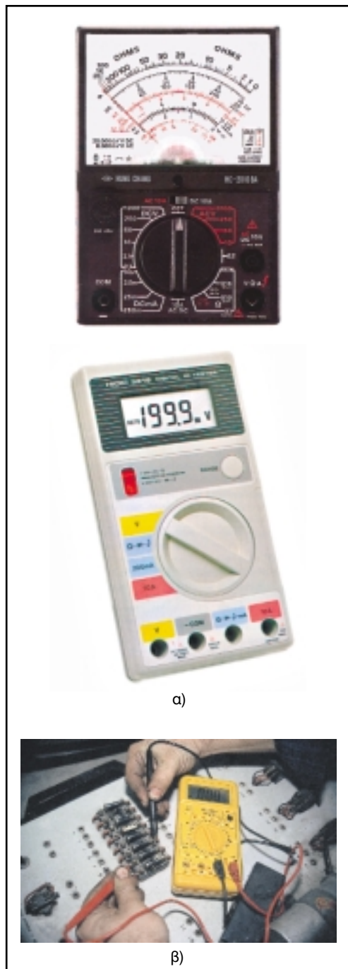
Σχήμα 4: α) Αναλογικό και ψηφιακό πολύμετρο β). Μέτρηση με πολύμετρο.
