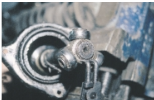
Σχήμα 8: Αφαίρεση του τρίποδα της φυσούνας και της τσιμούχας.
