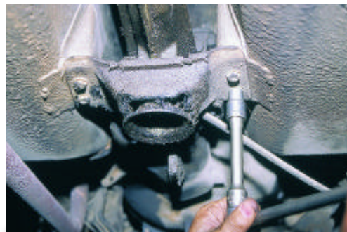
Σχήμα 7: Αφαίρεση ελαστικής βάσης.
