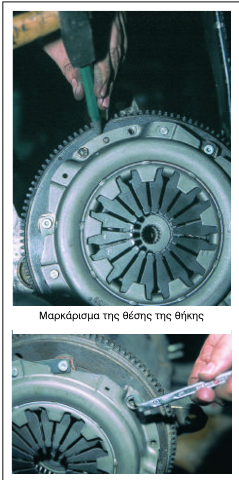
Σχήμα 3: Αφαίρεση συμπλέκτη.
