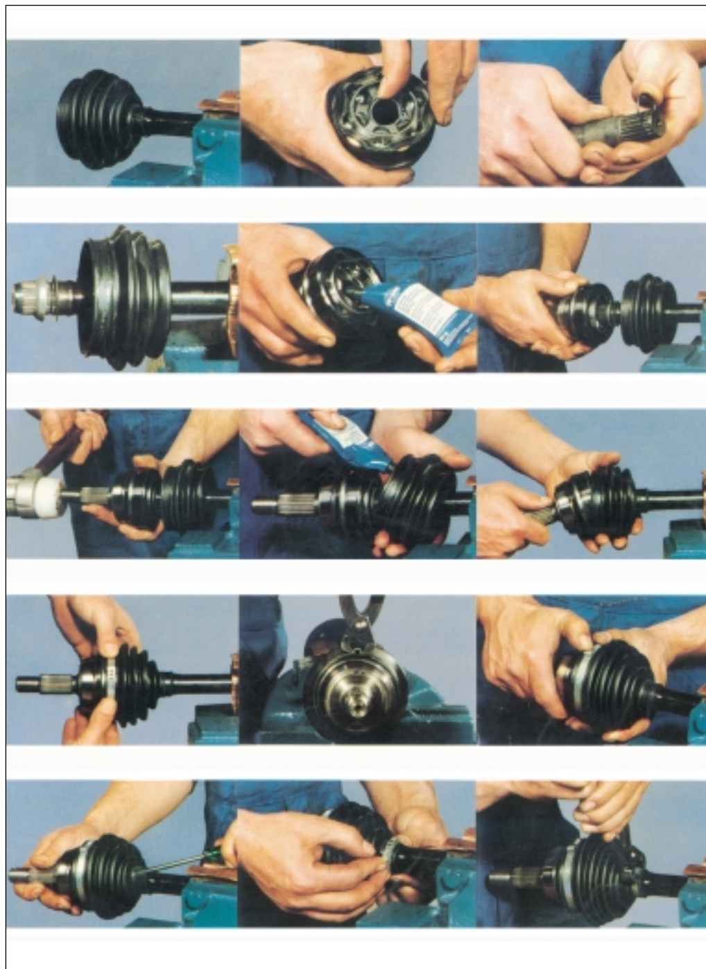
Σχήμα 9: Συναρμολόγηση του συνδέσμου με το ημιαξόνιο.
