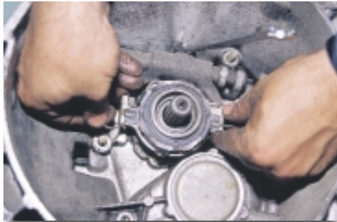
Σχήμα 13: Αφαίρεση των ασφαλειών και του ρουλεμάν του συμπλέκτη.
