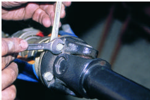
Σχήμα 5: Αποσύνδεση του κεντρικού άξονα.
