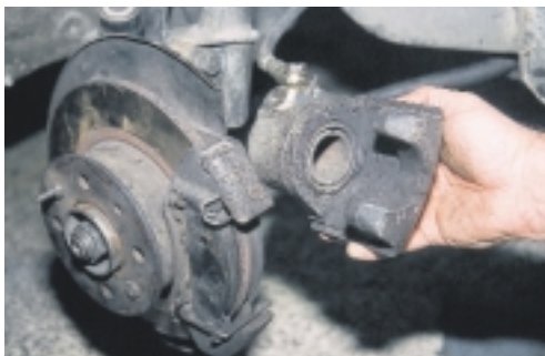
Σχήμα 5: Αφαίρεση της δαγκάνας.
