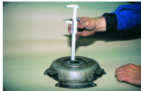
Σχήμα 4: Έλεγχος φθοράς και ύψους του ελατηριωτού διαφράγματος.
