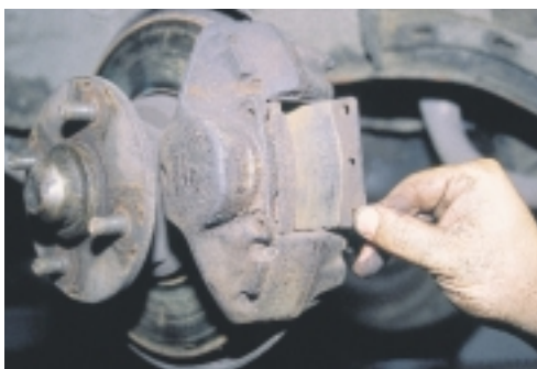
Σχήμα 9: Αφαίρεση τακακιών.
