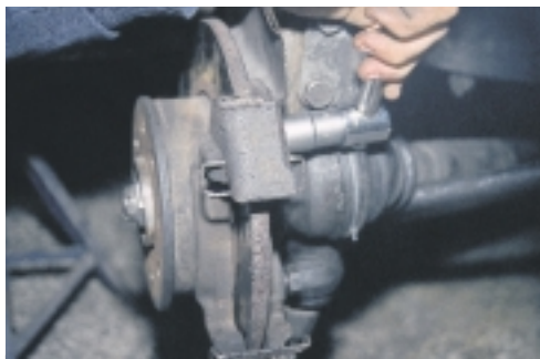
Σχήμα 12: Αφαίρεση του στηρίγματος του δισκόφρενου.
