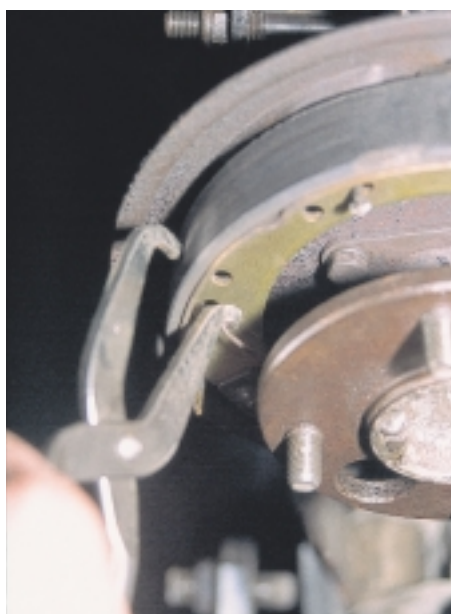
Σχήμα 2: Αφαίρεση ταμπουρόβιδων.
