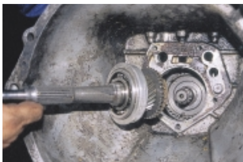
Σχήμα 18: Αφαίρεση πρωτεύοντα.
