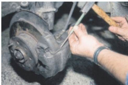
Σχήμα 4: Αφαίρεση της βάσης της δαγκάνας.
