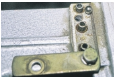
Σχήμα 15: Αφαίρεση της πλάκας συγκράτησης και των ασφαλειών.
