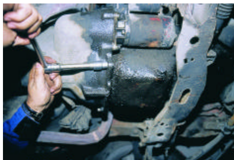
Σχήμα 8: Αφαίρεση των κοχλιών σύνδεσης του κιβωτίου ταχυτήτων με τον κινητήρα.
