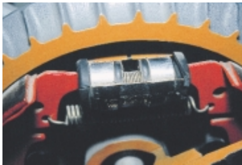
Σχήμα 1: Κύλινδρος τροχού διπλής ενέργειας.
