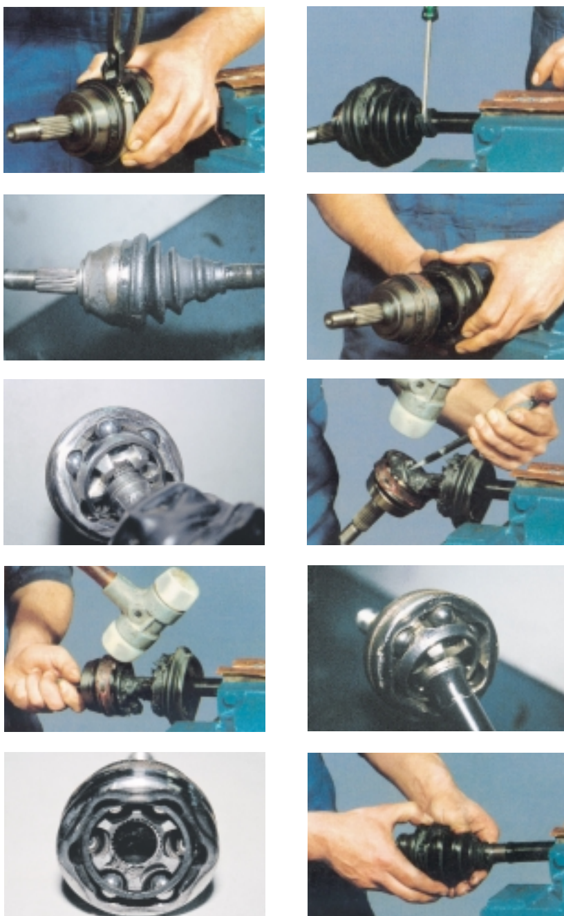
Σχήμα 7: Διαδικασία αποσυναρμολόγησης του συνδέσμου.
