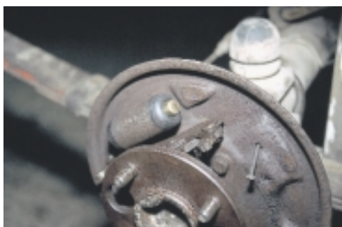
Σχήμα 6: Καθαρισμός ταμπόρου.
