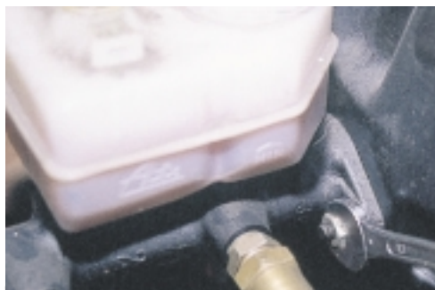
Σχήμα 3: Αφαίρεση της κεντρικής αντλίας φρένων από το σερβομηχανισμό.
