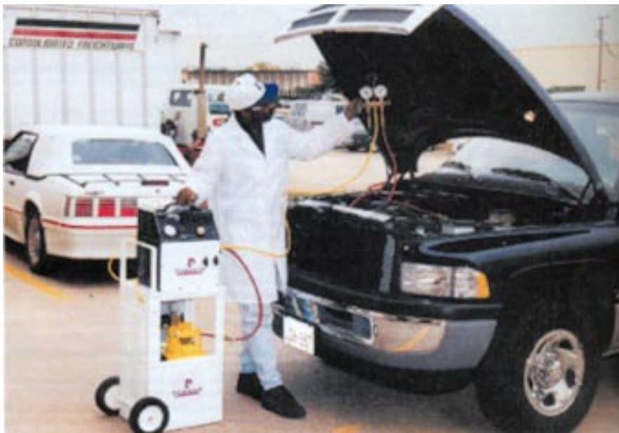
Εικόνα 6.2: Σύνδεση σετ μανομέτρων στο σύστημα κλιματισμού.
