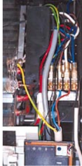
Εικόνα 3.16: Ηλεκτρικό κύκλωμα εσωτερικής κλιματιστικής μονάδας.
