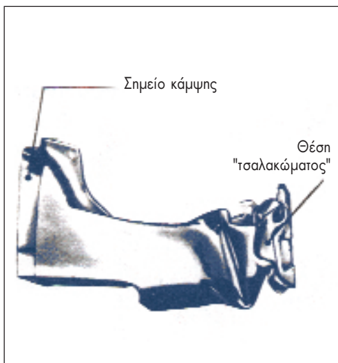
Σχ.1.44 Ζώνη απορρόφησης ενέργειας (τμήμα επιμήκους δοκού αμαξώματος).
