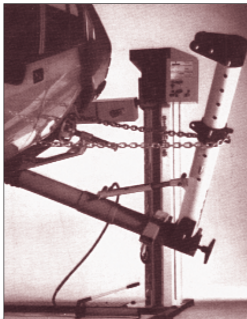
Σχ. 1.55 Μηχανή έλξης (τραβήγματος) αμαξώματος
