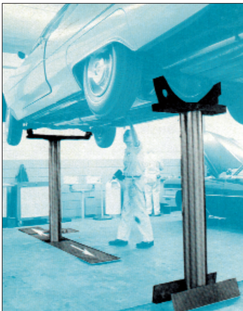
Σχ.1.60 Ανυψωτήρας δύο βραχιόνων (κολώνων).
