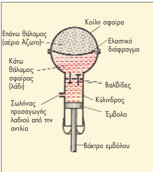
Σχ.4.59 Συγκρότημα εμβόλου - σφαίρας από υδροπνευματική ανάρτηση.
