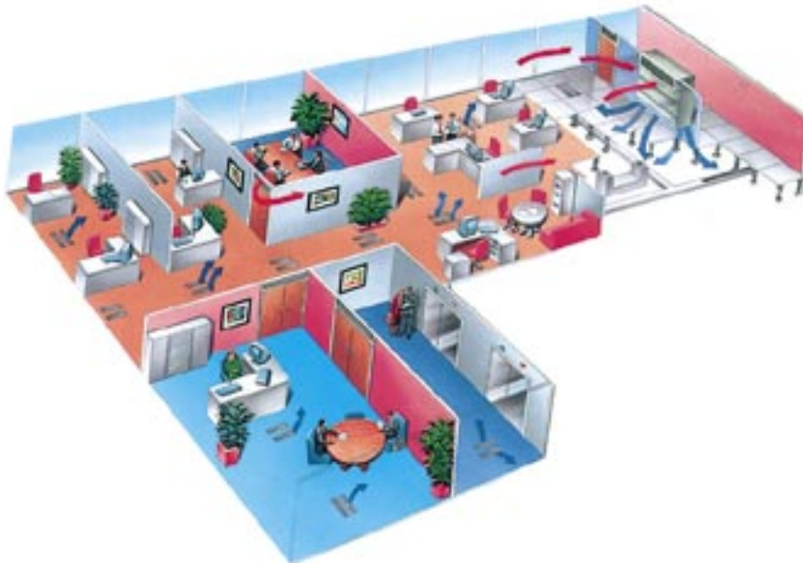
Σχήμα 8-67: Κλιματισμός συγκροτήματος γραφείων με μονάδα κλειστού κυκλώματος
