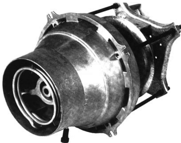
Σχήμα 9-16: Το βασικό εξάρτημα του στομίου (9-15) που ρυθμίζει την παροχή του αέρα.
