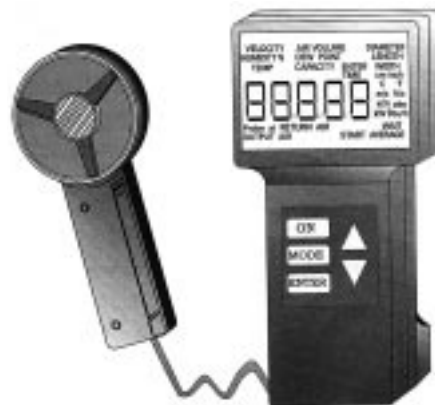
Σχήμα 4-6. Ψηφιακό πολύμετρο για τη μέτρηση των στοιχείων του αέρα.
