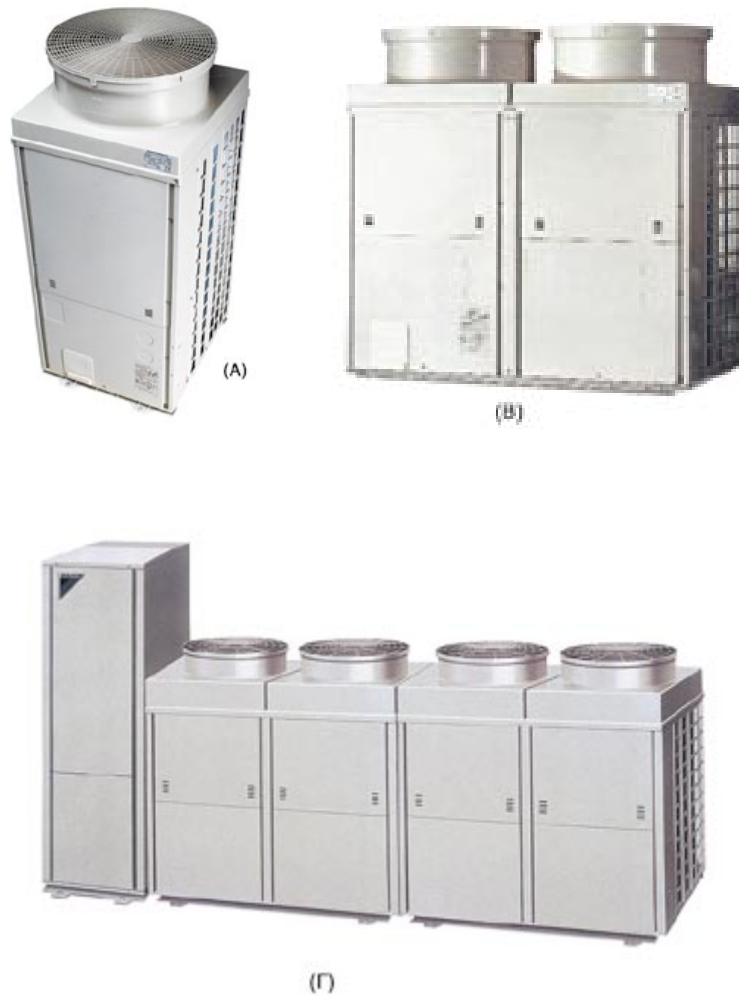
Σχήμα 6-2: Εξωτερικές μονάδες συστήματος VRV κατάλληλες για μέχρι (Α) 8 εσωτερικές κλιματιστικές μονάδες (Β) για μέχρι 16 (Γ) για μέχρι 30
