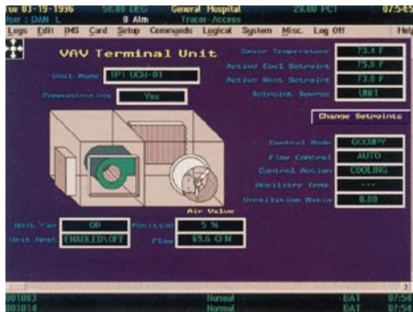
Σχήμα 10-20. Ο έλεγχος των στοιχείων θερματικής μονάδας κλιματισμού, όπως εμφανίζεται στην οθόνη του Η/Υ σε κεντρικό σύστημα διαχείρισης κτιρίων (B.M.S.).
