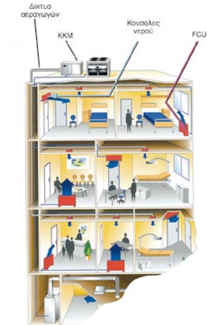
Σχήμα 9-12: Ένα σύστημα με αποστολή προκλιματισμένου αέρα και με ΤΚΜ
