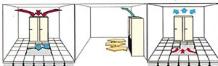
Σχήμα 8-65: Εγκατάσταση μονάδων κλειστού κυκλώματος σε ψευδοδάπεδο
