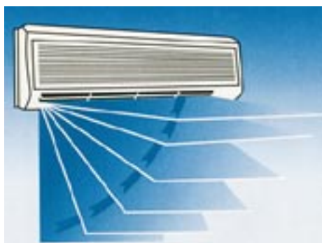
Σχήμα 8-11: Ρύθμιση της κατεύθυνσης ροής του αέρα σε κονσόλα, μέσω πτερυγίων
