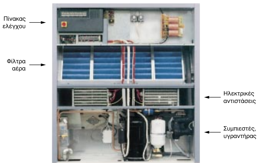
Σχήμα 8-68: Το εσωτερικό μονάδας κλειστού κυκλώματος, με ερμητικούς συμπιεστές. Η ονομαστική ισχύς της είναι περίπου 30 kW.
