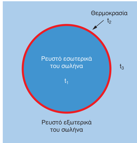
Σχήμα 7-1: Εναλλαγή θερμότητας μεταξύ δύο ρευστών που το ένα ρέει μέσα από ένα σωλήνα ενώ το άλλο βρίσκεται εξωτερικά του σωλήνα
