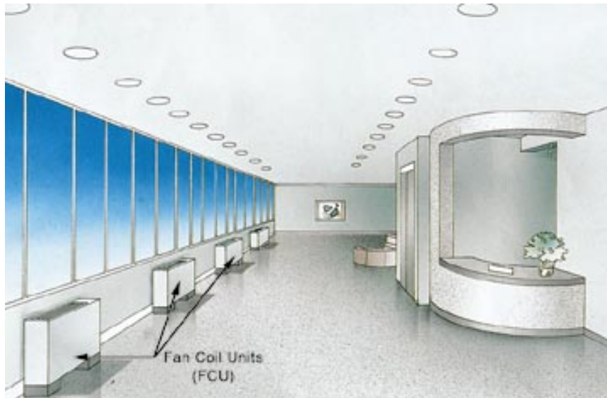
Σχήμα 1-3. Κεντρική εγκατάσταση κλιματισμού με Fan-Coils δαπέδου.
