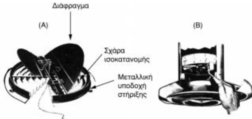
Σχήμα 5-8. Κυκλικά στόμια οροφής στα οποία φαίνονται τα εξαρτήματα από τα οποία αποτελούνται. Α. Κυκλικό στόμιο οροφής με τα εξαρτήματά του. Β. Ρύθμιση διαφράγματος (τάμπερ) στομίου.
