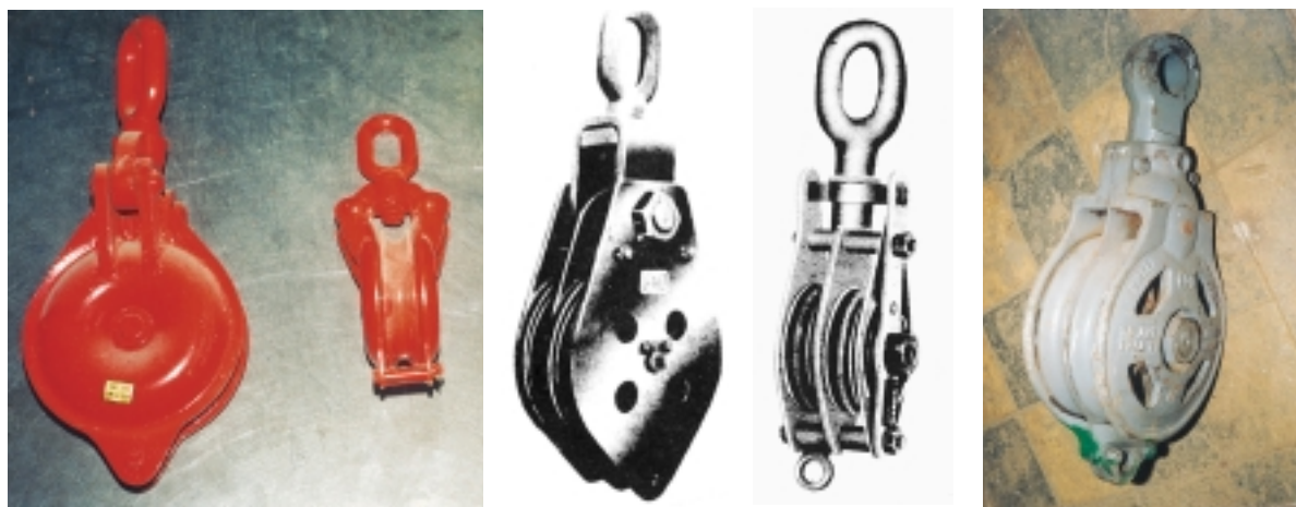
Εικόνα 11.3: Διάφορα είδη τροχίλων που χρησιμοποιούμε μέσα στα πλοία
