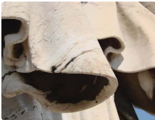
Όξινη προσβολή και μαύρη κρούστα σε άγαλμα λόγω ατμοσφαιρικής ρύπανσης. Λεπτομέρεια από το κτίριο-μνημείο της Ακαδημίας Αθηνών.
