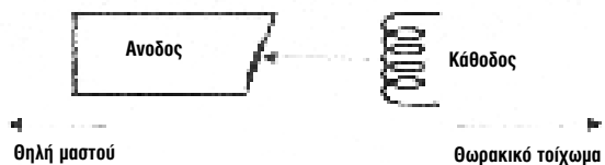
Σχ. 5.2.: Η ακτινολογική λυχνία είναι τοποθετημένη έτσι, ώστε η άνοδος να είναι προς την πλευρά της θηλής και η κάθοδος προς την πλευρά του θωρακικού τοιχώματος
