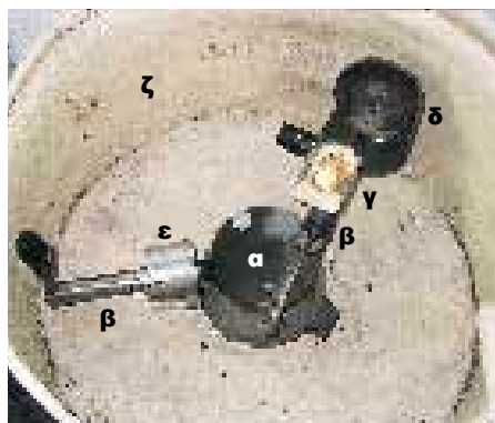
Εικόνα 7.39.: Αποτελούμενα τμήματα συσκευής χύτευσης με φυγόκεντρο δύναμη:
