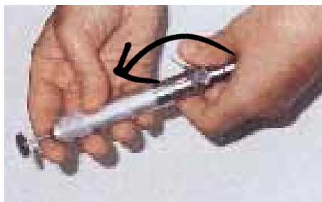
Εικόνα 7.12.(γ): Συγκράτηση και σταθεροποίηση του μικροεργαλείου με μετακίνηση της πεταλούδας.
