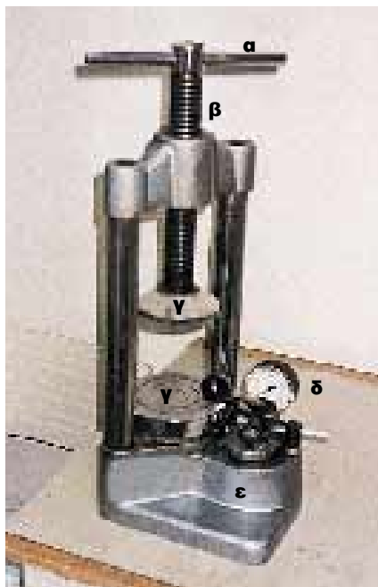
Εικόνα 7.25.:Υδραυλικό πίεστρο.(α): Μοχλός του κοχλιώδη σφιγκτήρα(β): Κοχλιώδης σφιγκτήρας.(γ): Επάνω και κάτω πλάκα της συσκευής.(δ): Μανόμετρο.(ε): Θάλαμος του λαδιού.
