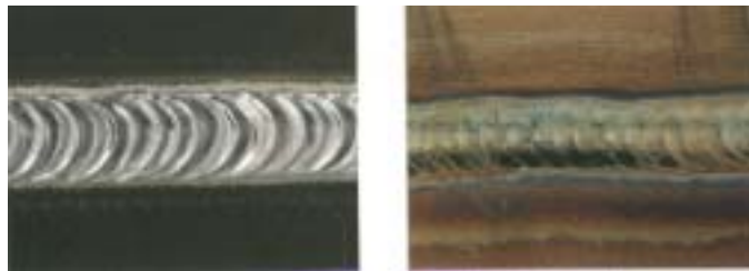
Σχήμα (6.22): Η μορφή της ραφής TIG: (A) Σε αλουμίνιο (B) Σε ανοξείδωτο χάλυβα πάχους μόλις 0,5 mm
