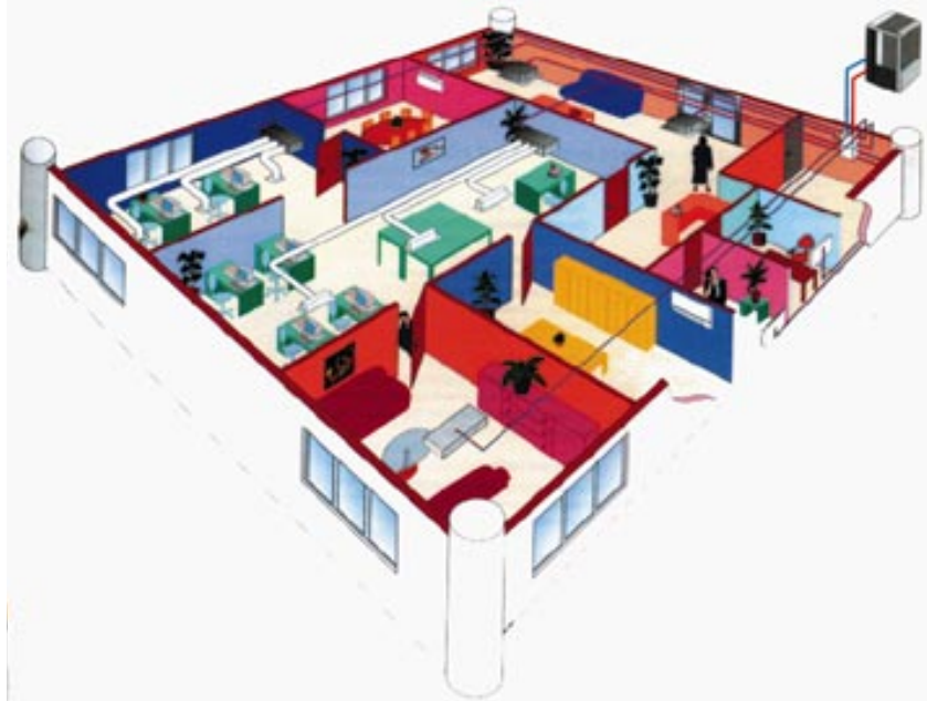
Εικόνα 5.4: Κεντρική εγκατάσταση κλιματισμού σε ένα μεγάλο χώρο γραφείων.
