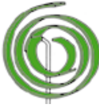
Σχήμα 4.4 Σπειροειδές διμεταλλικό έλασμα
