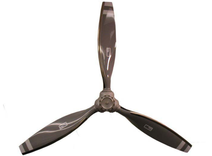
Σχήμα 2.45 Διαμόρφωση της γεωμετρίας στη ρίζα πτέρυγας εμβολοφόρου κινητήρα
