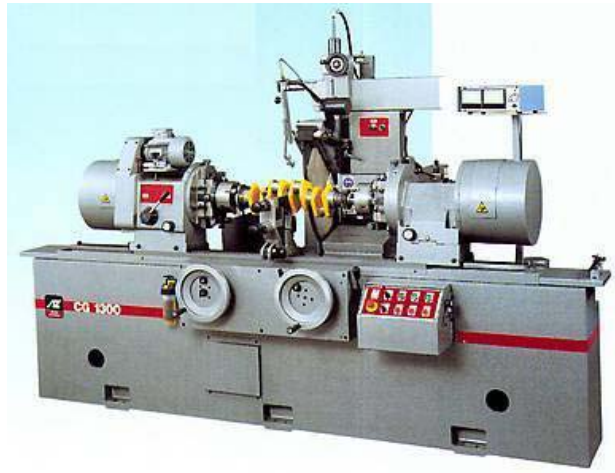
Σχήμα 2.23 Μηχανουργική κατεργασία λείανσης των σημείων στήριξης στροφαλοφόρου άξονα
