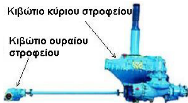
Σχήμα 2.40 Κιβώτιο υποπολλαπλασιασμού στροφών κύριου και ουραίου στροφείου
