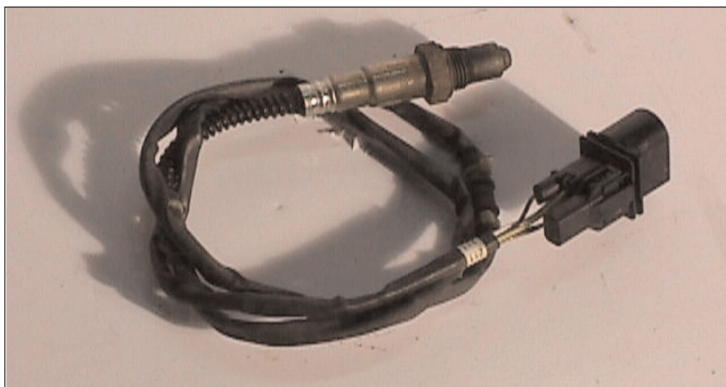
Εικ. 4.5.4 Θερμαινόμενος αισθητήρας "λ"
