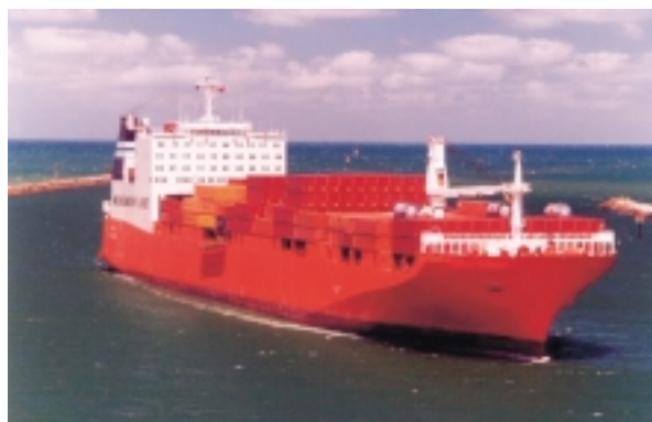
Εικόνα 3.10 (β): Πλοίο μεταφοράς εμπορευματοκιβωτίων. Ένα μέρος του φορτίου του φορτώνεται στο κατάστρωμα με μορφή «χαβαλέ».
