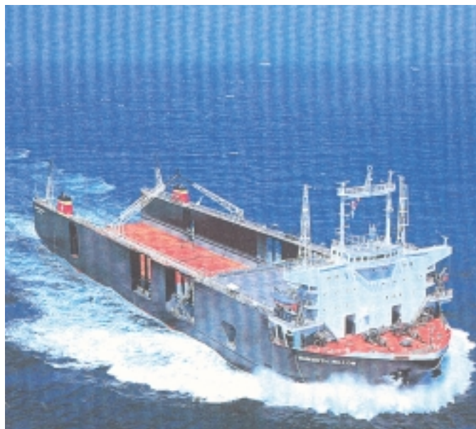
Εικόνα 3.13: Φορτηγιδοφόρο πλοίο τύπου Lash Feeder (ή του γνωστού τύπου SEABEE). Οι φορτηγίδες φορτώνονται και εκφορτώνονται στο πλοίο, επιπλέοντας στο νερό (βυθίζεται αντίστοιχα το πλοίο). Το πλοίο αυτό μπορεί να φορτώνει ταυτόχρονα φορτηγίδες και εμπορευματοκιβώτια.
