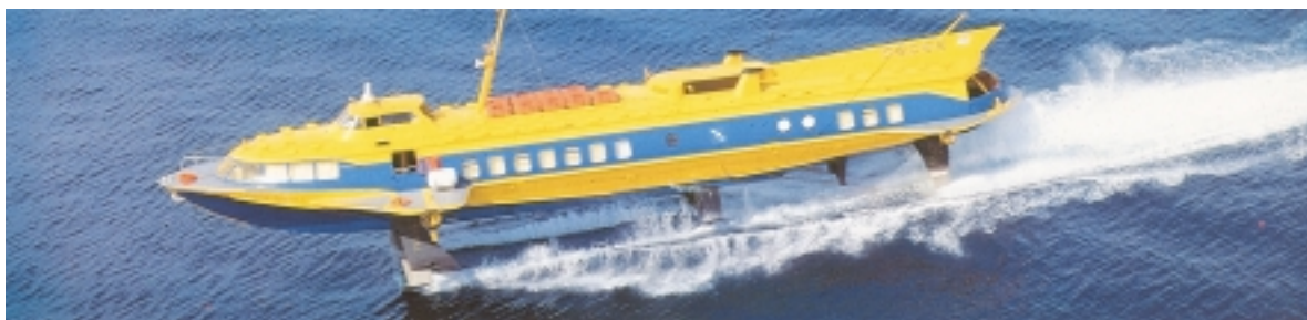
Εικόνα 3.25: Μικρό επιβατηγό πλοίο τύπου Ιπτάμενου δελφινιού (Flying Dolphin)
