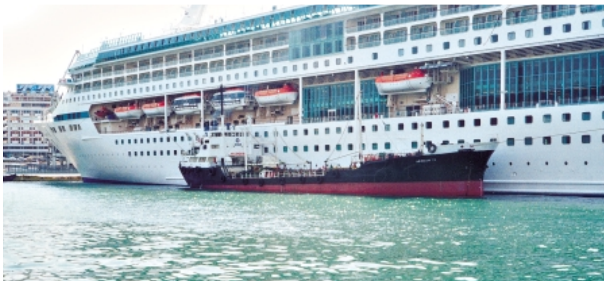
Εικόνα 3.39 (β): Πλοίο ανεφοδιασμού υγρών καυσίμων (μπονκεράδικο). Στην εικόνα φαίνεται το πλοίο αυτό που εφοδιάζει με καύσιμα ένα μεγάλο κρουαζιερόπλοιο που είναι προσδεμένο στο λιμάνι.
