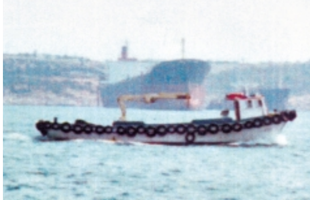
Εικόνα 3.40 (β): Μικρό βοηθητικό πλοίο το οποίο χρησιμοποιείται για τη μεταφορά διαφόρων εφοδίων (μηχανήματα, εργαλεία, ανταλλακτικά, διάφορα υλικά κτλ.) από και προς τα πλοία.
