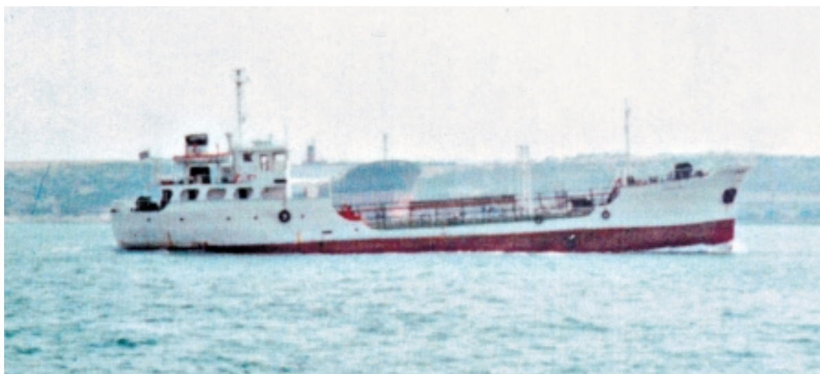
Εικόνα 3.39 (α): Πλοίο ανεφοδιασμού υγρών καυσίμων (μπονκεράδικο)
