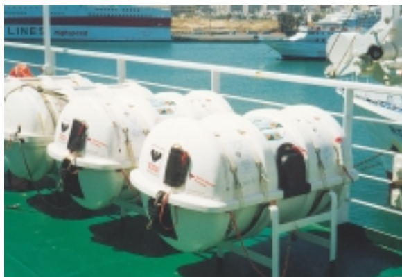
Εικόνα 8.7: Σωσίβιες σχεδίες (βαρελάκια) μέσα στο κέλυφός τους
