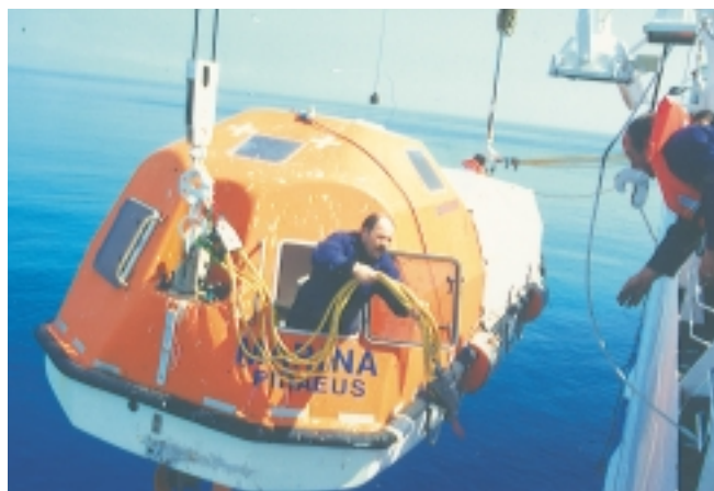
Εικόνα 8.16 (β): Καθαίρεση σωσίβιας λέμβου με επωτίδες βαρύτητας, φαίνονται τα σχοινιά προσαγωγής που δένονται πλώρα και πρύμα.
