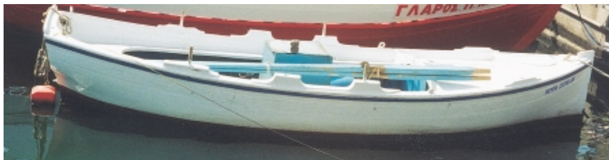
Εικόνα 8.1 (α): Ξύλινη λέμβος λείας αρμολογίας
