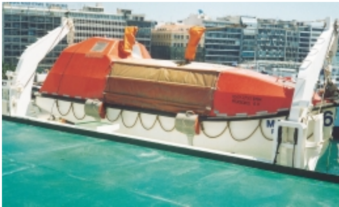
Εικόνα 8.4: Σωσίβια λέμβος μερικώς κλειστού τύπου στη θέση στοιβασίας της
