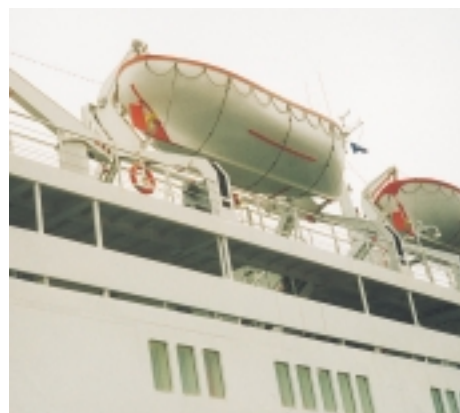
Εικόνα 8.3: Σωσίβια λέμβος ανοιχτού τύπου, όπου φαίνεται το σωσίβιο σχοινί και στο κάτω μέρος η χειρολαβή για τη συγκράτηση των ναυαγών
