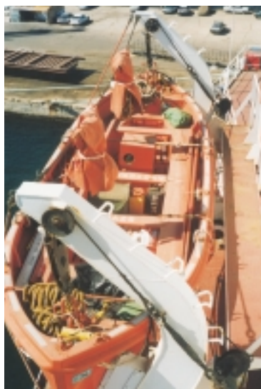
Εικόνα 8.2: Σωσίβια λέμβος ανοιχτού τύπου στη θέση στοιβασίας της
